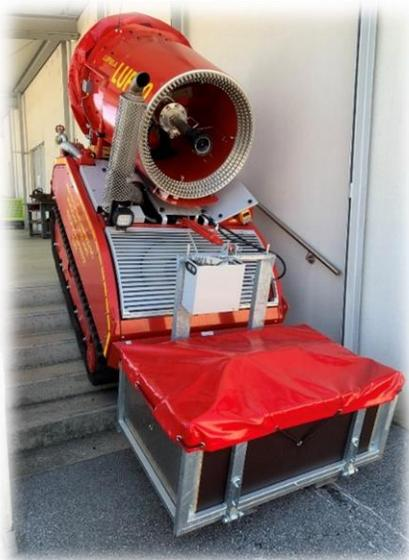
Großer Vorteil des selbstfahrenden Gerätes ist die Fernsteuerbarkeit (bis zu 300m bei freier Sicht) wodurch das Gerät aus einem sicheren Bereich aus gesteuert werden kann, ohne dass sich der Fahrer im Gefahrenbereich aufhalten muss.
